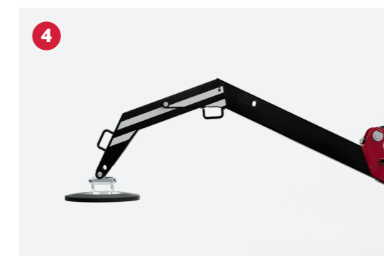
4 Knikpoten De C6e beschikt over geïntegreerde knikpoten. De stempelpoot bevindt zich standaard laag bij de grond, zodat deze onder obstakels kan worden uitgeschoven. Trek de knikpoot naar buiten wanneer u de stempelpoten over een obstakel plaatst. De knikpoot komt ook van pas op ongelijk terrein.
